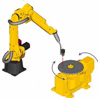
对使用一台控制装置进行协调控制的2台机器人的相对位置进行校正。可以对应2台都是机器人，或者其中1台是变位机的机器人系统。有助于提高协调控制的精度。
