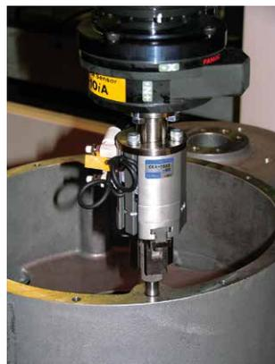
加工孔径的尺寸检查
